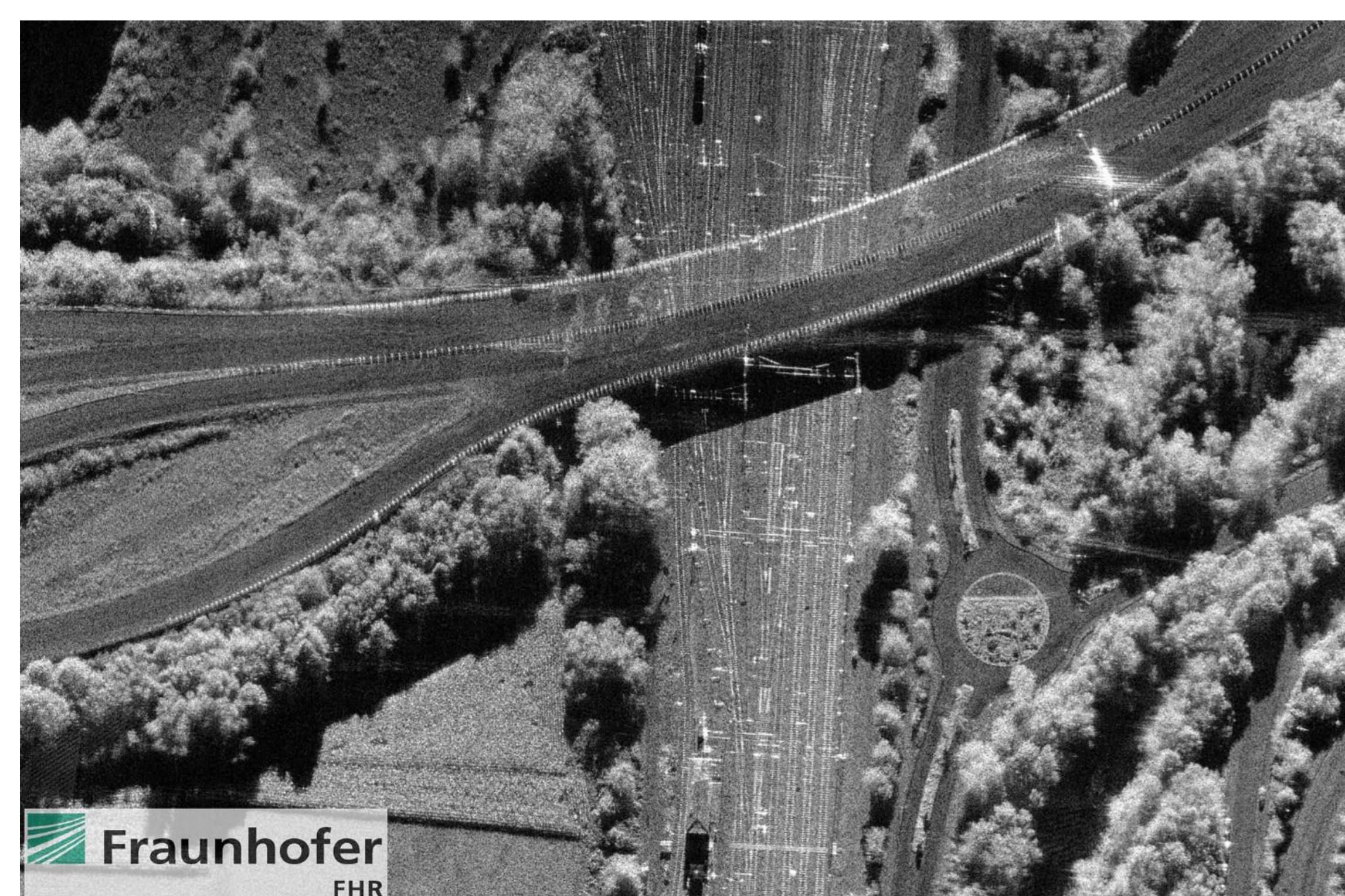
Hochauflösende Ka-band SAR-Abbildung einer Eisenbahnstrecke
